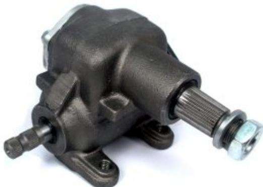
El sistema de dirección hidráulica o asistida –como también se le conoce–, funciona a través de una bomba que presuriza un líquido que es enviado por tubos y mangueras a la caja de dirección. En su interior, se ubican sellos que al recibir esta presión impulsan a las varillas de acoplamiento, que unen la caja de dirección con las ruedas, permitiéndoles desplazarse hacia la izquierda o la derecha y en el sentido de giro que el operador desea.
