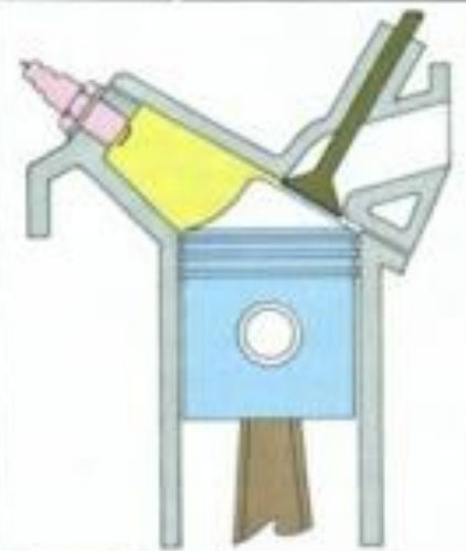
Trapezoidal lateral Rendimiento de la cámara, \eta_c = 0,98
