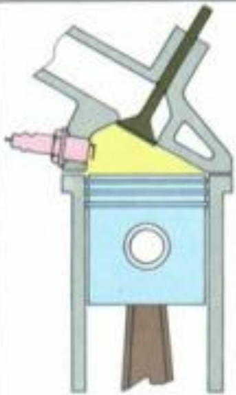
Triangular Rendimiento de la cámara, \eta_c = 0,99
