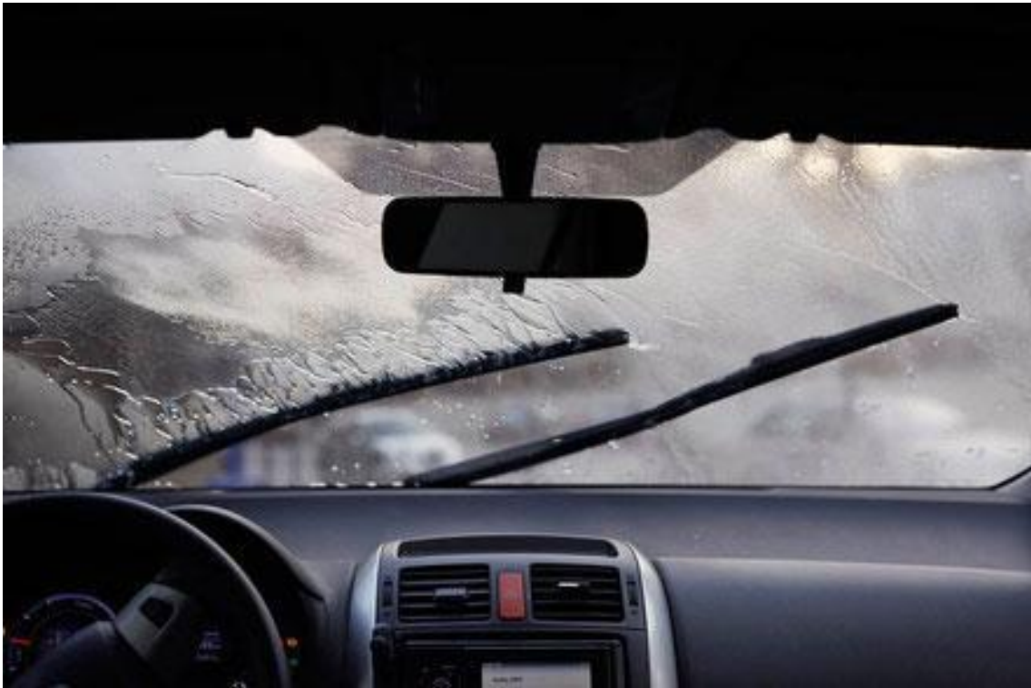
Disminución de la visibilidad por mal estado de las escobillas
