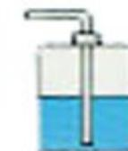
La disminución de la temperatura y de la presión al enfriarse el motor se traduce en un retorno a la situación inicial, el vacío creado absorbe el agua al radiador.
