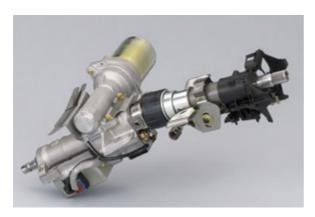
Básicamente la idea de este sistema es que la asistencia a la dirección no es Hidráulica, si no eléctrica, encontrándose una unidad de control electrónico denominada generalmente EPS (Electronic Power Steering), que comanda a un motor corriente directa sin escobillas generalmente, aunque pueden existir variantes. Este motor esta acoplado al sector de la dirección, y asiste al movimiento del conductor.
